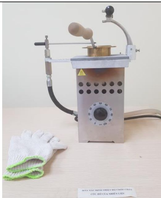
Máy xác định nhiệt độ chớp cháy cốc hồ Koehler K13990
