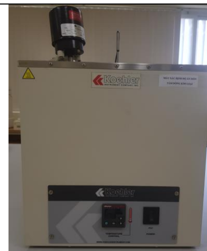
Thiết bị xác định độ ăn mòn của tấm đồng Koehler K25339
